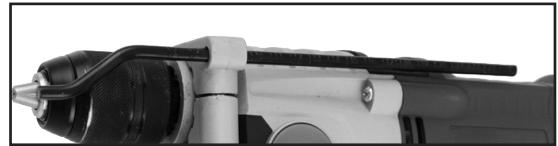
Tournez la poignée dans le sens inverse des aiguilles d'une montre (ou appuyez sur le bouton) pour la desserrer et insérez la butée de profondeur dans la poignée auxiliaire.
