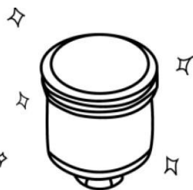
3. Pulire accuratamente la coppa del filtro del carburante.
