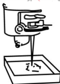
2. Svitare la valvola del carburante e scaricare tutto il carburante. (Modello: Unità semplice)
